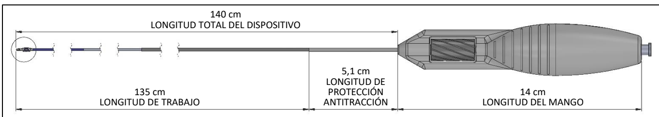
Figura 2: Longitudes del mango y el cuerpo del catéter Santreva™-ATK
